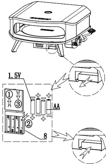
SCHRITT 2: Stellen Sie nach dem Einlegen der Batterien sicher, dass sich der Bedienknopf in der Position „OFF“ befindet, drücken Sie den Starter, um das LED-Licht einzuschalten, das LED-Licht zeigt weiße Farbe, drehen Sie den Bedienknopf gegen den Uhrzeigersinn, das LED-Licht wechselt zu rot. Denken Sie daran, den Starter erneut zu drücken, um das LED-Licht nach Gebrauch auszuschalten.
