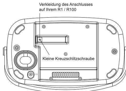
6. Nehmen Sie die kleine Kreuzschlitzschraube und die Verkleidung des Anschlusses und bewahren Sie beides für späteren Gebrauch auf.
