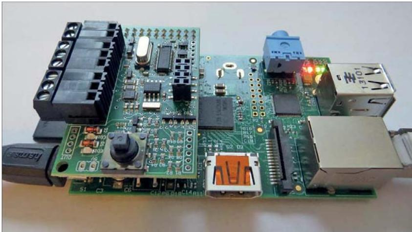
Abbildung 16.17 Das auf das alte Modell B gesteckte RasPiComm
