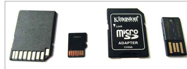
Abbildung 1.7 Eine SD-Karte in Standardgröße, eine Micro-SD-Karte, ein SD-Karten-Adapter sowie ein winziger USB-Adapter für Micro-SD-Karten
