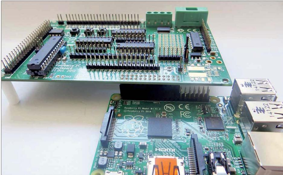
**Abbildung 16.3** Das Gertboard kann problemlos auf den Raspberry Pi 2 oder 3 gesteckt werden.
