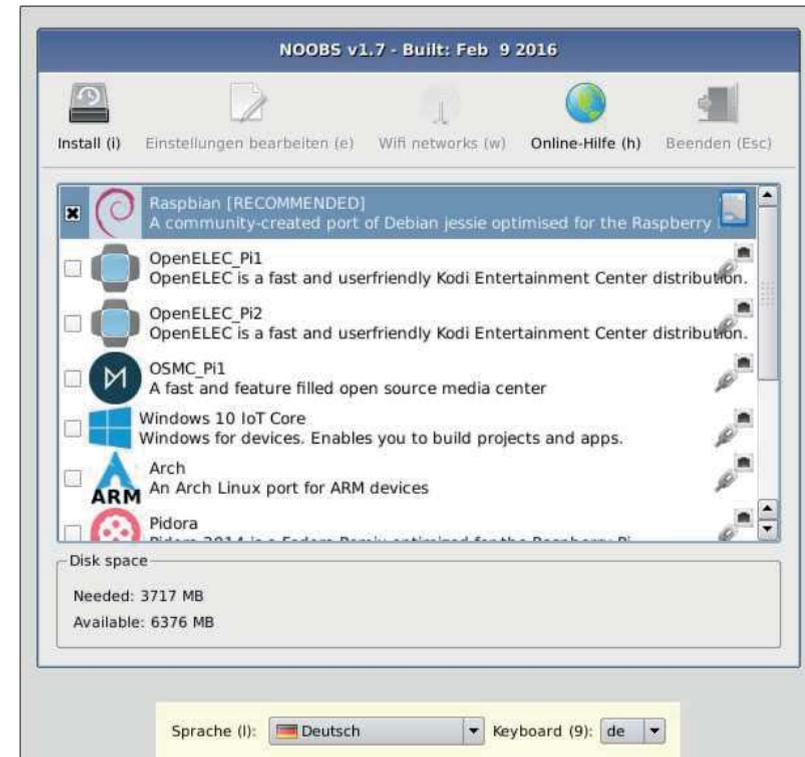
Abbildung 1.8 Das NOOBS-Installationsprogramm
