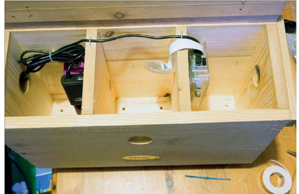
**Abbildung 26.2** Eine Kammer für die Stromversorgung, eine für den Raspberry Pi, eine für die Mieter
