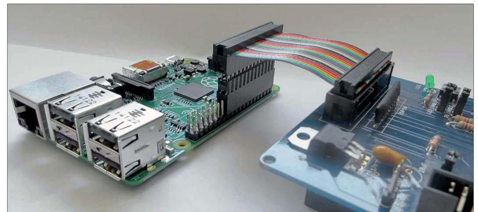
Abbildung 16.23 Das Quick2Wire-Board wird mit einem Stacking-Header an das Modell 3 angeschlossen.
